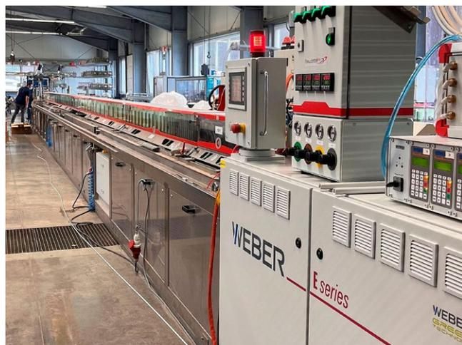
Для производства крупногабаритных основных профилей компания SLS дооснастила свой завод новыми экструзионными установками с почасовой выработкой от 300 кг и линией охлаждения более 18 м (все фото: SLS)
